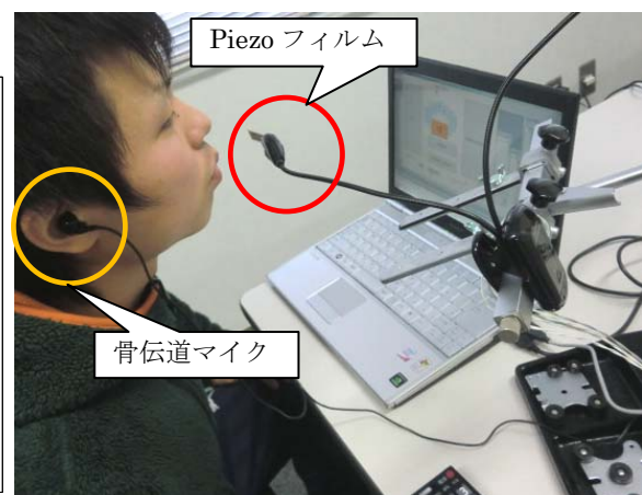
図 2. 歯音呼気マウスによる TV の制御
