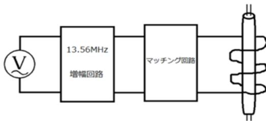
図3 無電極ランプ点灯回路
