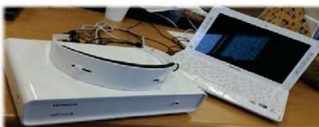
図1 近赤外分光脳計測装置
