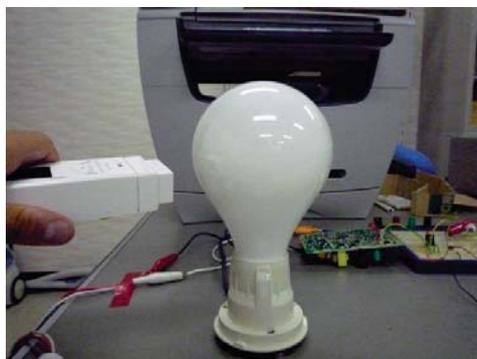
図1 無電極ランプによる可視光通信実験
